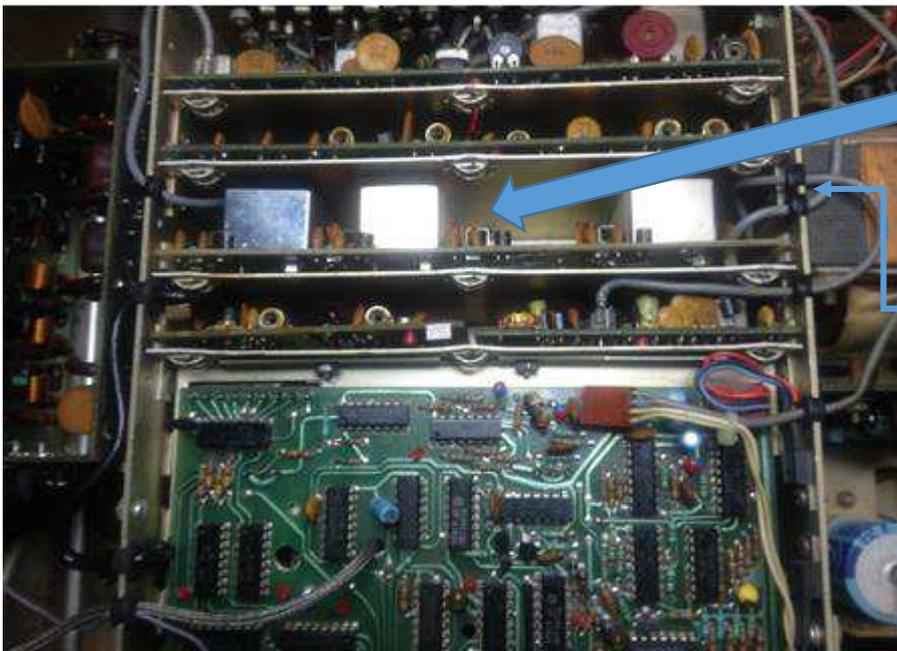
*La scheda con tre filtri opzionali installati. Non occorre rimuovere i cavetti schermati collegati; attenzione a riposizionare, a lavoro ultimato, i proteggi cavi in gomma (gommini neri) nelle apposite guide.*
