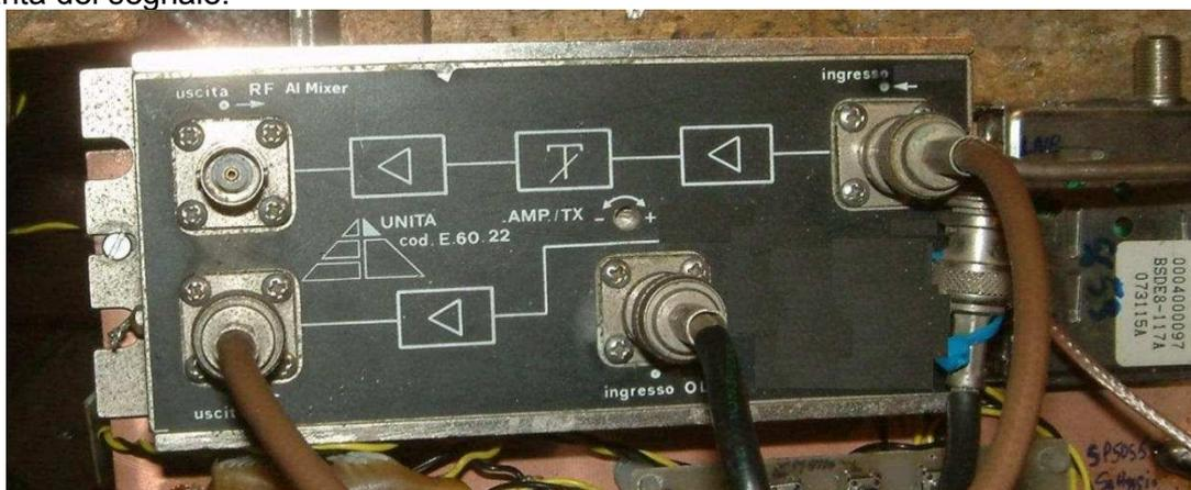
Inoltre la catena composta da due amplificatori ibridi ha una regolazione di guadagno permettendo di avere un' uscita tra un minimo di 5 dB e un massimo di 15 dB, segnale più che sufficiente a pilotare il Mixer.
