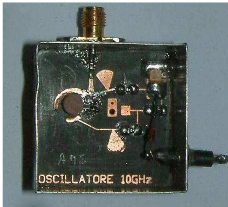
Fig. 17 L' oscillatore a DRO a 10 GHz
