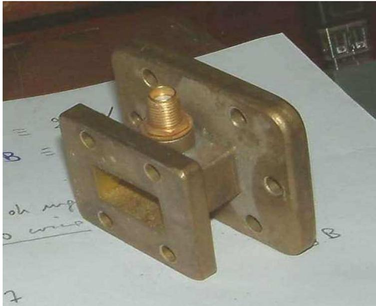
Fig.25 Il power monitor con la presa Sma per il prelievo di una parte di RF per L' AGC
