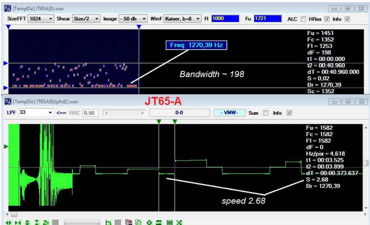
Misure di frequenze e manipolazione del segnale in JT65-A
