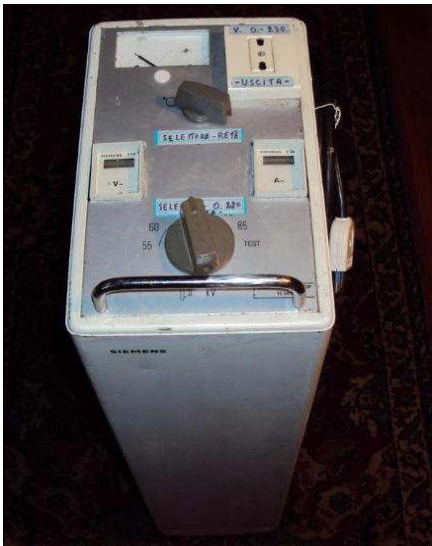
Ecco l'ultima mia realizzazione impegnativa , un alimentatore in alternata da **0 a 230V** da circa **1 KW** dotato di trasformatore di isolamento ed un sistema di regolazione quasi come un VARIAC utilissimo per alimentare apparecchi vintage sprovvisti di trasformatore come quasi tutti i televisori degli anni settanta o apparecchi radio e registratori dotati di autotrasformatori .
