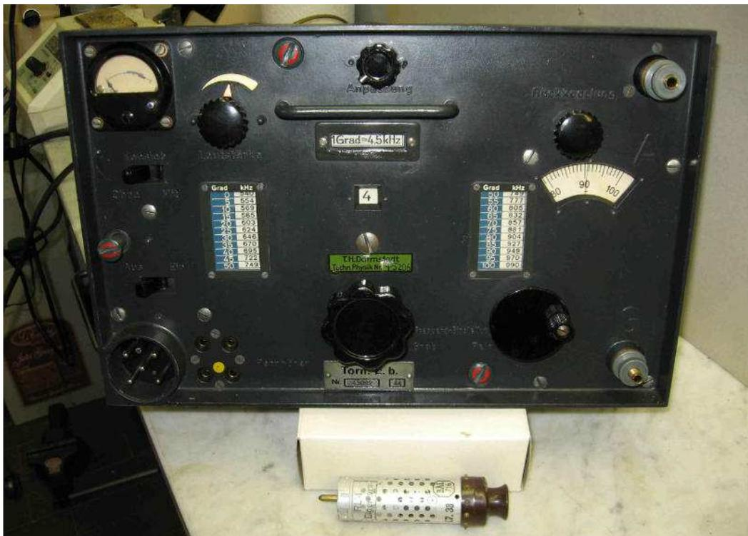
Uso campale ( spalleggiabile) ricezione **AM e CW** con filtro ad 800 Hz in bassa frequenza ;il segnale d'antenna incontra due stadi ad alta frequenza, un detector a reazione ed uno stadio di bassa con uscita in cuffia ad alta impedenza, questo è il semplice circuito.
