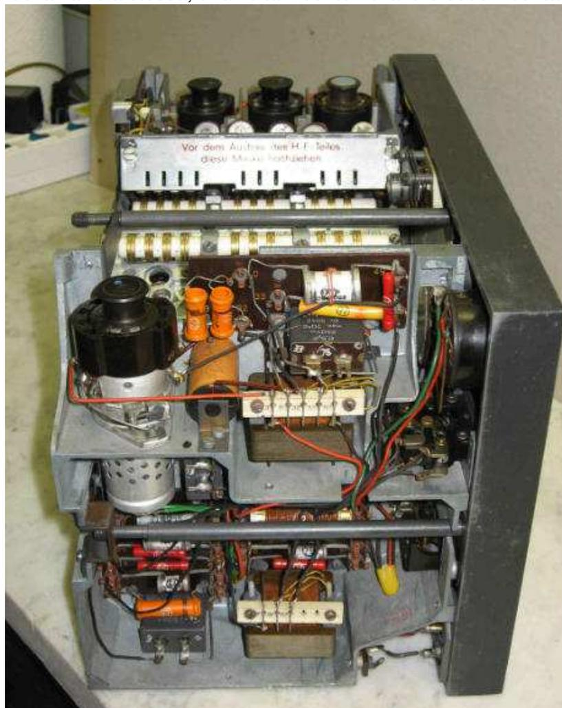
Al centro dello chassis troneggia l'imponente tamburo rotante, 8 gamme con gruppi di 3 bobine per gamma, ogni bobina è avvolta su adeguato supporto per ottenere il Q più alto possibile e schermata da un carter, i contatti sono in oro fissati su barrette in ceramica per evitare perdite di radio frequenza.
