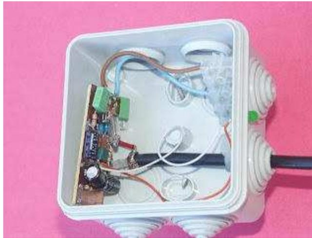
Vista assemblaggio Box Amplificatore. E visibile il Led monitor presenza alimentazione
